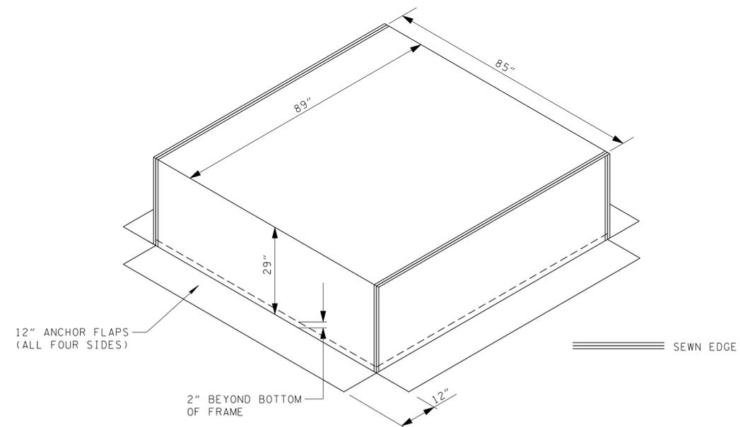
**GEOTEXTILE SLIPCOVER FABRICATION**
